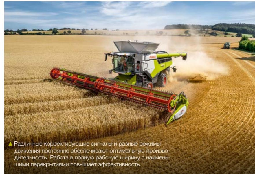
▲ Различные корректирующие сигналы и разные режимы движения постоянно обеспечивают оптимальную производительность. Работа в полную рабочую ширину с наименьшими перекрытиями повышает эффективность.
