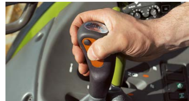
Благодаря четырем ступеням переключения под нагрузкой во многих случаях не требуется смена групп.
