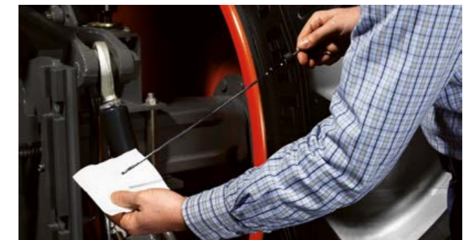
Простой контроль уровня трансмиссионного масла в задней части.
