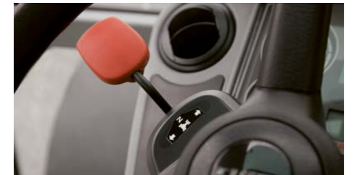
Механизмом реверсирования REVERSHIFT механизатор управляет кончиками пальцев.
