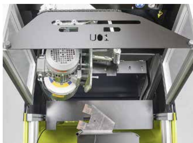
Заточка прямых ножей по оригинальному контуру.
