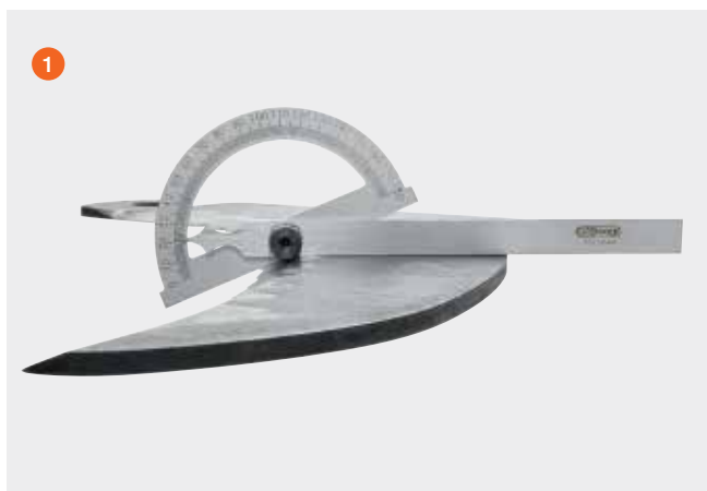
Нож с неправильным углом заточки ( 22^\circ ), заточенный с помощью ручной машины.
