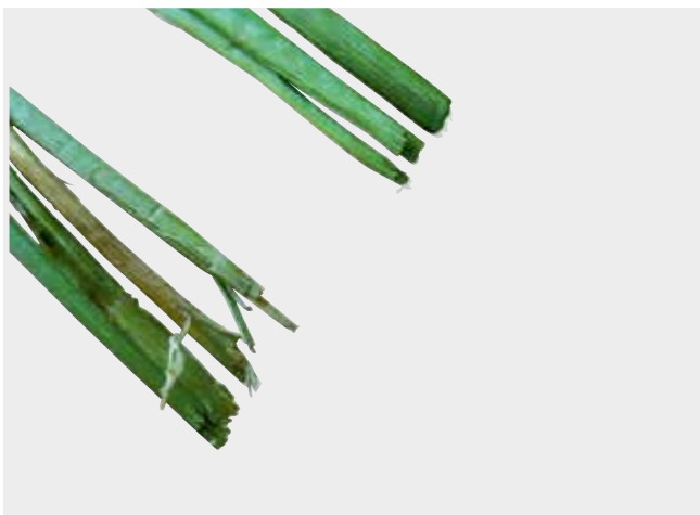
Срез зеленой массы тупыми ножами.
