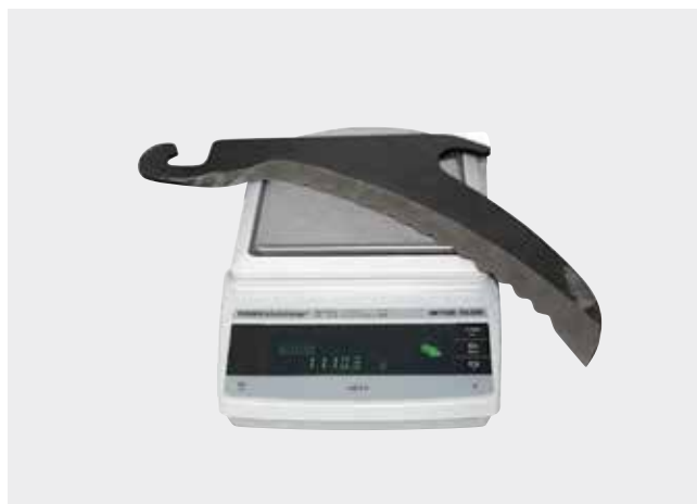
Нож, сточенный до макс. предела заточки: 1,1 кг.
